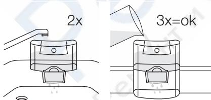
Извлеките воронку из модуля фильтра BRITA, заполните ее холодной водой из под крана и дождитесь, чтобы вся вода прошла через фильтр.
