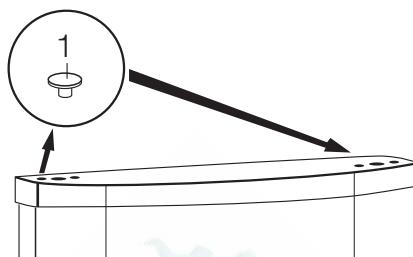
7. Отвинтите поворотный штифт верхней петли (t1) и привинтите на противоположной стороне.
